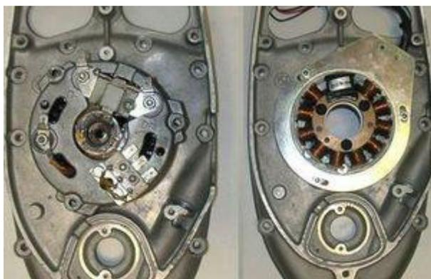
Umístěte předmontovanou desku statoru na skříň místo původního alternátoru.
