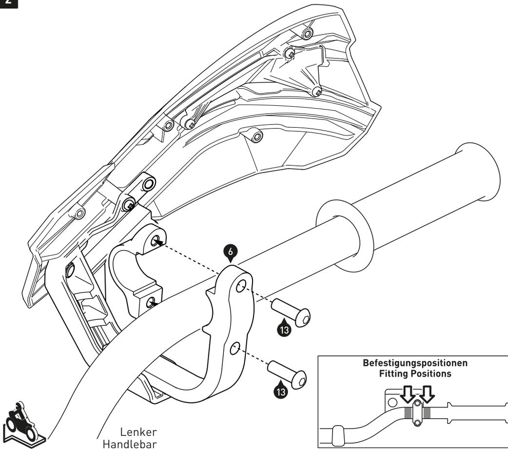
*HINWEIS: Die Montage ist rechtsseitig dargestellt. Wiederholen Sie die Montage mit den entsprechenden Teilen auf der linken Lenkerseite analog zur rechten Lenkerseite.*
